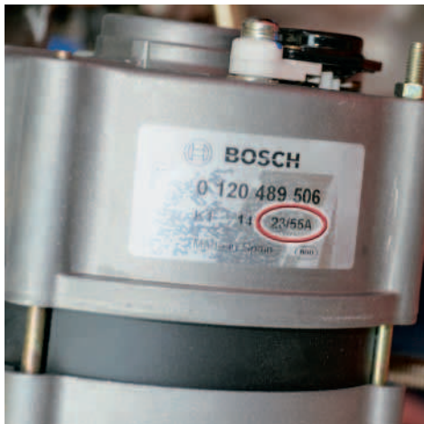
1.2 Typenschild eines Generators: Maximale Stromabgabe 55 A. Bild: Thomas Mareis
