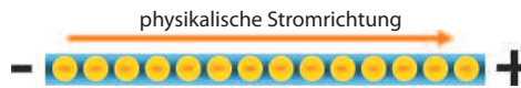
1.5 Physikalische Stromrichtung: In metallischen Leitern fließt elektrischer Strom immer vom Minuspol einer Batterie zum Pluspol.
