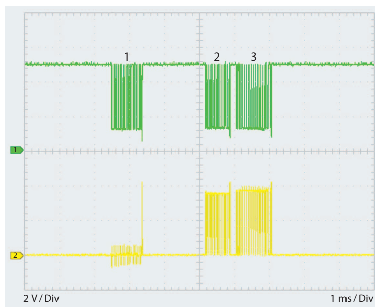
Abbildung 35: Messung mit dem Oszilloskop: Unterbrechung einer CAN-H-Leitung, Diagramm mit drei Botschaften.
